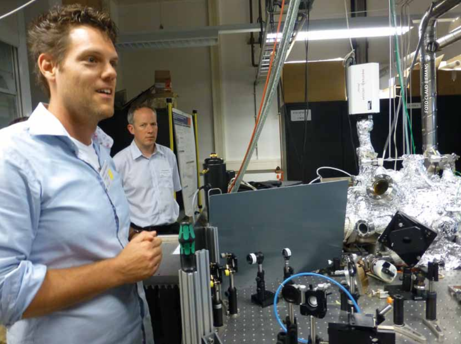
Vincent Vandalon bij de opstelling voor somfrequentiemetingen, die kunnen uitwijzen hoeveel van welke chemische groepen op een oppervlak aanwezig zijn. Geen koud kunstje om dat voor elkaar te krijgen.
