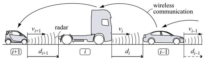
Fig. 2. CACC-equipped string of vehicles.
