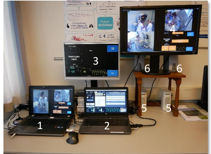
Figuur 23 - Close-up van de gehele set-up. Te zien zijn: de video-evaluatiesysteem laptop (1), de laptop met monitorsoftware, trainerscherm (2), de gedubliceerde monitor van de simulatieruimte (3), het meekijk-scherm voor de overige deelnemers (4), de speakers voor het live mee-luisteren (5), de speakers voor het afspelen van de evaluatievideo's (6) en de trainer-microfoon (7).
