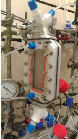
Figuur 6: Alkalische water elektrolyse cel gemaakt middels 3D printen
