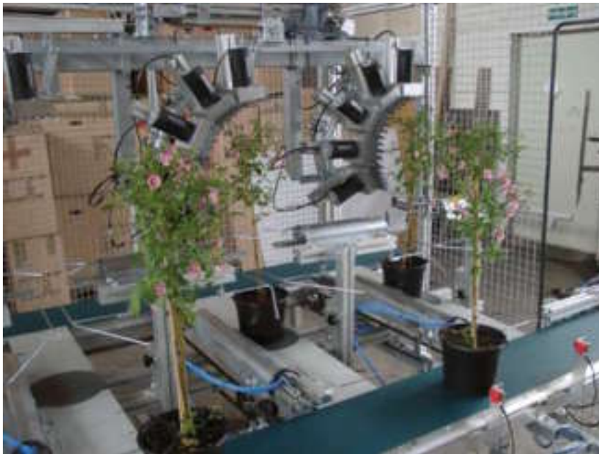
Automatische vormsnoeimachine: de arbeid verschuift van repeterende arbeid naar toezicht op machines en onderhoud.
