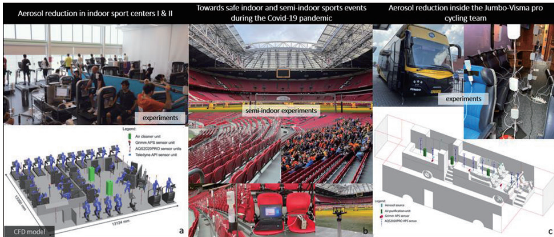
図1 TU/e が実施した SARS-CoV-2 プロジェクト。(a)TU/e のスポーツセンター、(b)アムステルダムの Johan Cruijff ArenA スタジアム、(c)プロサイクリングチーム Jumbo-Visma のバス
