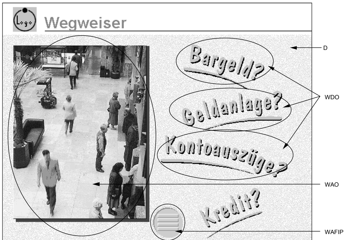
Abbildung 10: Die multimediale Benutzungsoberfläche (GUI) mit beispielhaft gekennzeichneten Elementen des Objekt- und Funktionsraumes.
