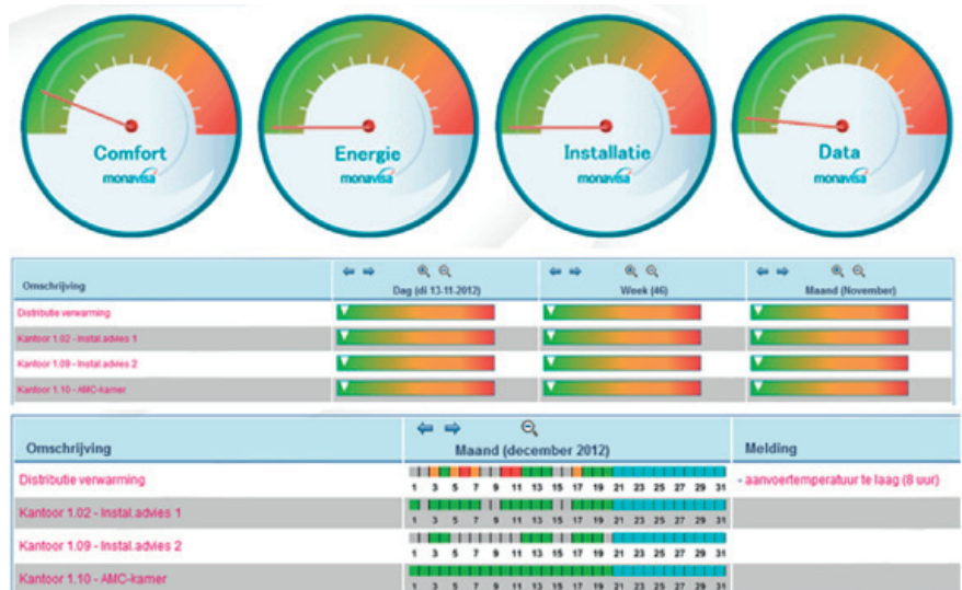
-Figuur 1- Web-interface en de verschillende niveaus waarop informatie getoond wordt. Van boven naar beneden: algemeen overzicht voor iedere categorie; overzicht van de dagelijkse, wekelijkse en maandelijkse prestatie van iedere gemonitorde ruimte; gedetailleerd overzicht en beoordeling voor iedere tijdstap met meldingen voor iedere ruimte ( www.monavisa.info )
