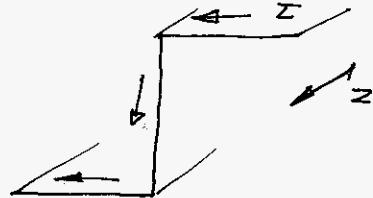
De lineair met de afstand tot de profiellijn veranderende schuifspanning is gegeven door de maximale waarde:
