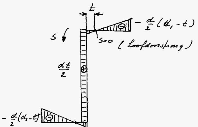
Een grootte die voor het schuifspanningsverloop van belang is, is het statisch moment van het afgesneden stuk van het oppervlak:  $S_w(q)$ , waarbij  $q$  de hoogte is gemeten van de rechte lijn van het profiel
