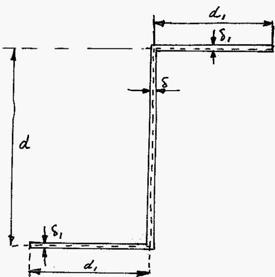
Gegeven is de dwarsdoorsnede van het Z-profiel, gekarakteriseerd door  $d$ ,  $d_1$ ,  $s$  en  $s_1$ .
