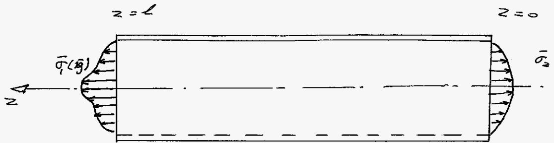
Alleen aan het lichaam wordt gehakt in axiale richting, zodat de resultante alleen een kracht in die asrichting levert. Aan de eindvlakken zijn geen schuifspanningen.
