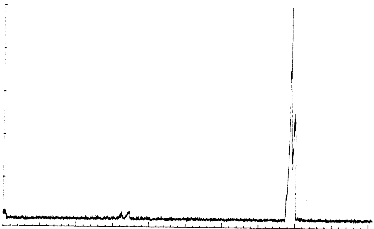
figuur 3.2.2 In de volgende drie massaspektrogrammen is de druk in de expansieruimte ( P_{ch} ) veranderd, deze is resp. 0.1, 1.0 en 4.5 Torr. De andere instellingen zijn: Ar flowrate ( Ar_{fl} ) 2.50 l/min, I_b = 60 A, V_{kath} = -76 V, P_b = 452 mBar.
