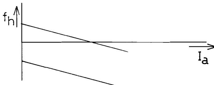
figuur 3.8a De zwarte band bij een te sterk hulppoolveld.
